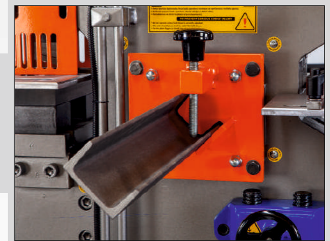
Köşebent Ve Npu Kesim Bölümü Angle Iron And Npu Cutting Section
