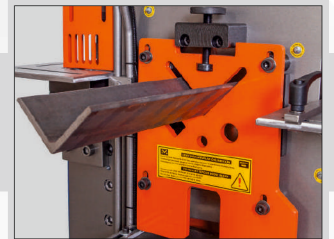
Köşebent Ve Npu Kesim Bölümü Angle Iron And Npu Cutting Section
