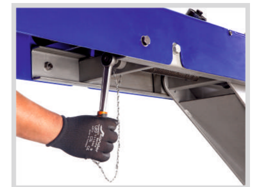
Aşağı Ve Yukarı Hareketi Sağlayan Makas Sistemi Mechanism For Moving Up And Down
